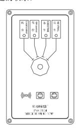
通过 ATE 联系的内容为: 驾控、机旁控制位置转换及备车、完的请求和应答。 机旁的 ATE 上设有一个切换开关(驾控、机控、备车、完车),用于确定请求和应答的两个部位。
