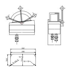
MH 为手柄式的,具有明显手感的无级调速形式,防护等级为 IP22。 MH 的主要功能是:发出转速指令信号和齿轮箱离合器的正、倒转指令信号。
